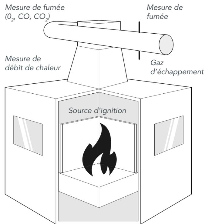
Essai d'objet isolé au feu SBI
